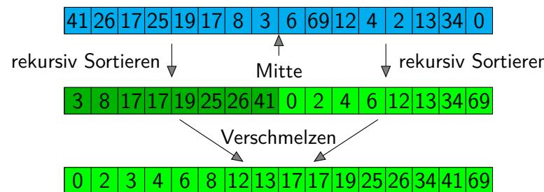
Teile das Array in zwei —möglichst gleichgroße— Hälften.
